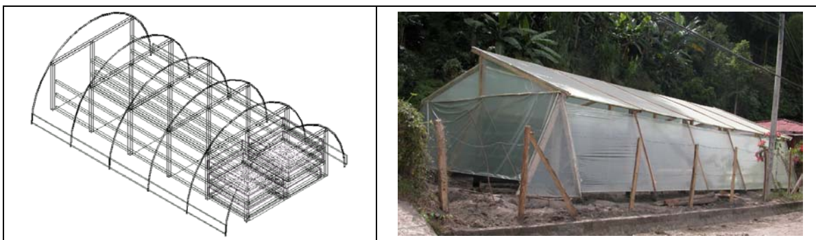
Figura 24. Estructuras de secado tipo invernadero.
