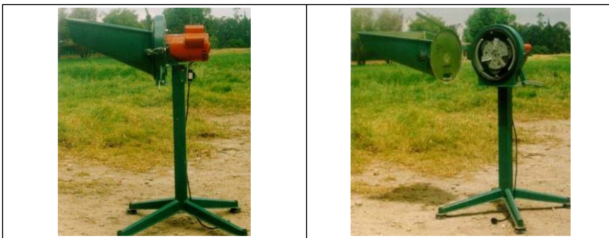
Figura 29. Molino de martillos tipo Ocmus.
