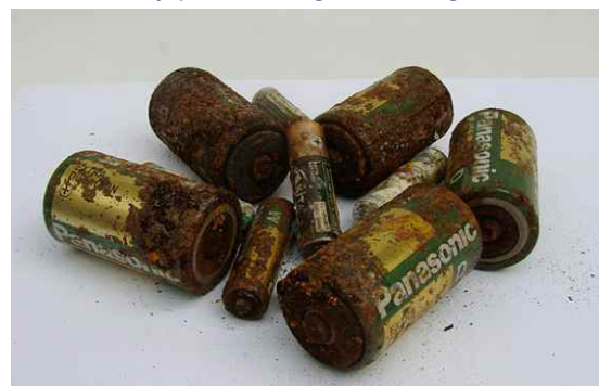
Pilas corroídas. Foto: Mariana Loayza
