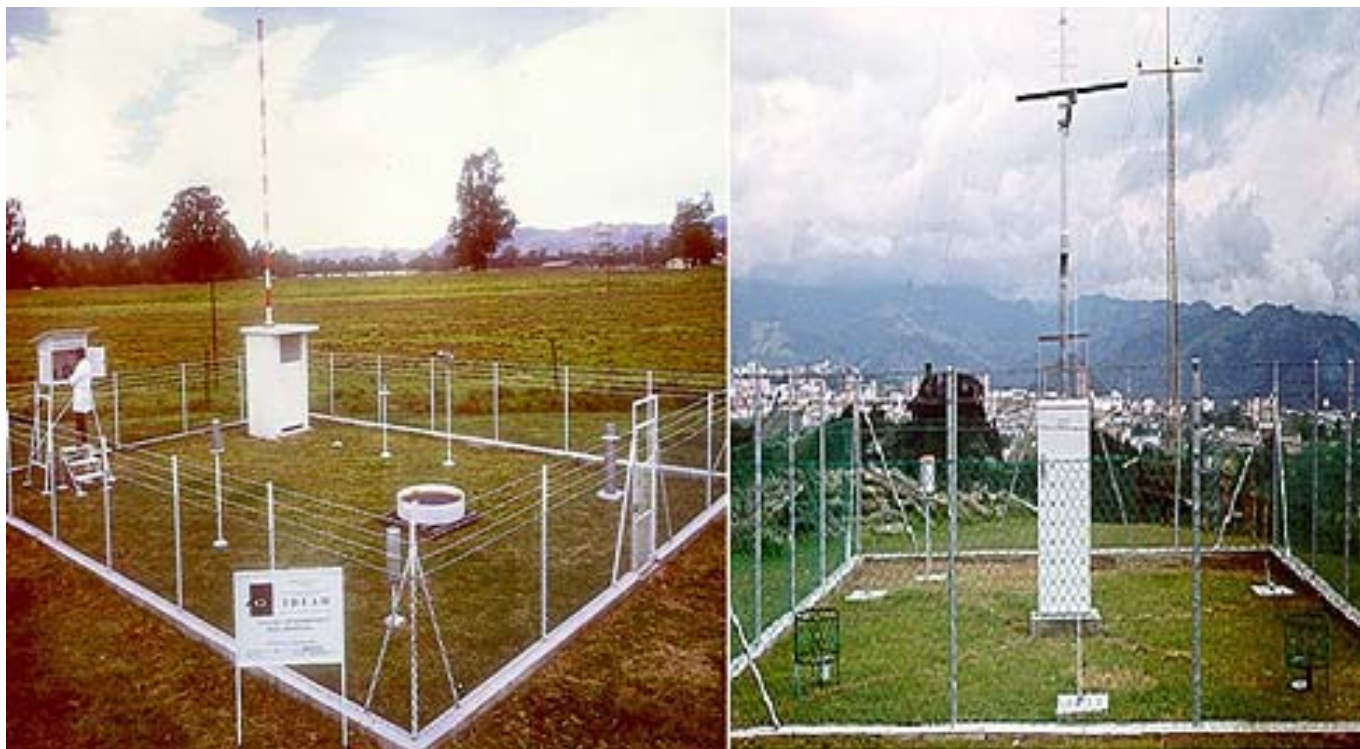
Figura 2. Estaciones meteorológicas de superficie, convencional (izquierda) y automática (derecha)
